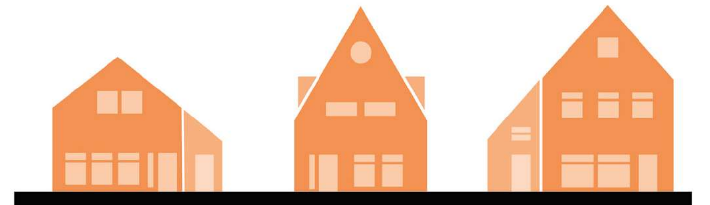
Ritmiek in de gevel, aanbouw als onderdeel van het hoofdgebouw zonder wandvorming te creëren
